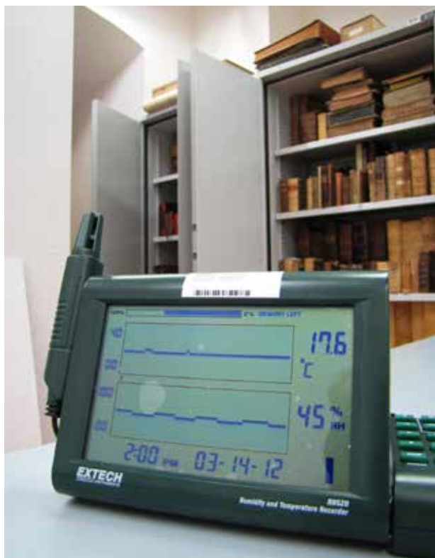
Merjenje vlage in temperature v depozu. (foto: Andreja Moškon)
